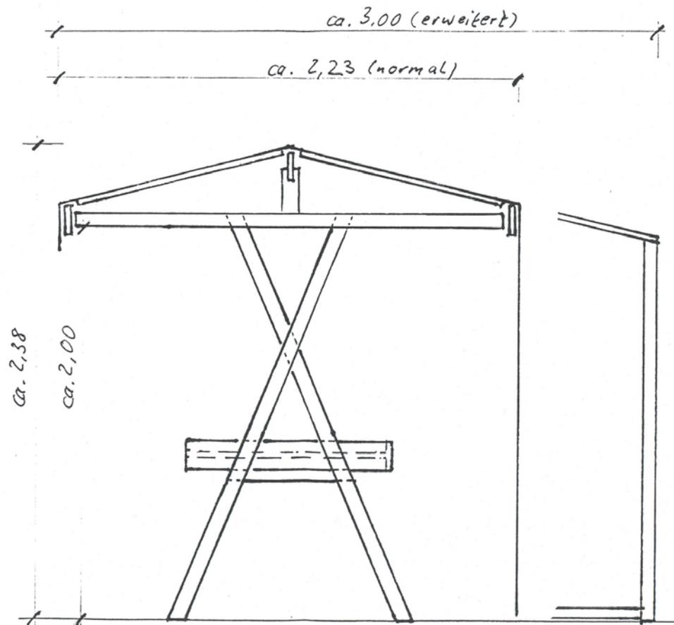
erweiterte Bauweise Rückwand versetzt
